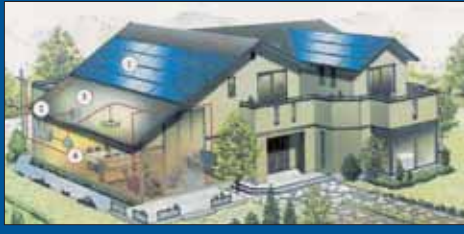
PANO 2: Güneş enerjisi sisteminin (1. panel - 2. şarj kontrolleri- 3. regülatör-4. akü) bir ev içine yerleşimini gösteren şekil.
